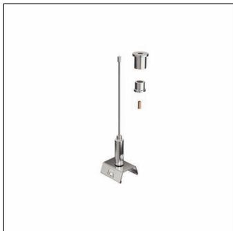
Licross®, dispositif de suspension par câble, douille de plafond, en acier inoxydable (V2A), brillant, diamètre: 1,5mm, câble, en acier, galvanisé, fixation côté rail, en acier à ressort V2A, unité d'emballage: 1 jeu = 25 pièces
