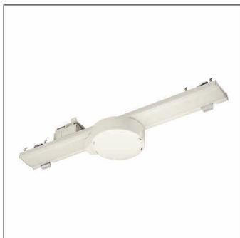
Licross® capteur D1, esclave, contrôle centrale - connexion à l'éclairage ou à la gestion du bâtiment, contrôle local - technologie de capteur autonome, gradable, type de pose: encastré, emplacement de pose: sur le rail Licross®, en tôle d'acier, degré de protection (total): IP20, classe de protection (total): classe de protection I (mise à la terre), marquage: CE, UKCA, tension: 120..277V, type de tension: AC, 1 x capteur de luminosité, 1 x DALI-2, unité d'emballage: 1 pièce
