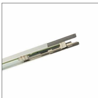
Modario, rail, en tôle d'acier, laqué, blanc brillant, à deux longueurs, longueur: 2.990 mm, largeur: 58 mm, hauteur: 43mm, câblage continu: 7x 2,5mm<sup>2</sup>, avec borne, 7 broches, 2,5mm<sup>2</sup> max., degré de protection (total): pour un degré de protection IP20/IP40, classe de protection (total): classe de protection I (mise à la terre), marquage: CE, ENEC, VDE, norme: EN 60598, unité d'emballage: 1 pièce
