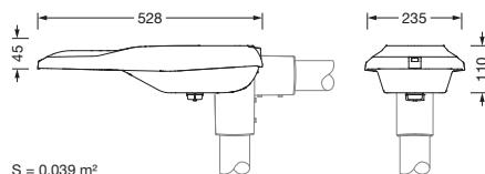
**N° de commande:** 5XE1M31U08CB | **GTIN (EAN):** 4058352923092**Description technique détaillée:**
