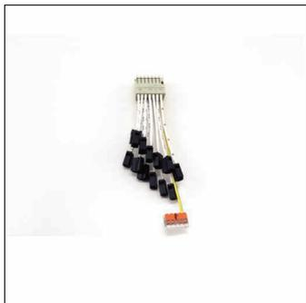
Licross® sortie pour câble flexible bornier 'sortie d'alimentation', gris galet 30 broches, 26x max. 2,5mm<sup>2</sup>, 4x max. 4mm<sup>2</sup>; sortie pour câble flexible borne de connexion pour 13 conducteurs, massifs ou souples, max. 2,5mm<sup>2</sup> et 13 conducteurs, massifs, max. 2,5mm<sup>2</sup> et 4 conducteurs (PE) massifs ou souples, max. 4mm<sup>2</sup>; marquage: CE, UKCA; unité d'emballage: 1 pièce
