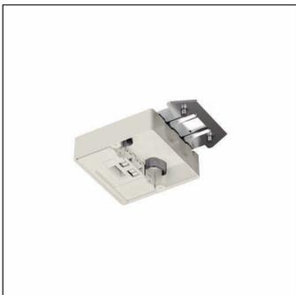
Highbay 11Interface MD, master, controllo locale - sensori autonomi autosufficienti, dimmerabile, tipo di montaggio: a plafone, luogo di montaggio: su apparecchio di illuminazione, in materiale plastico, grado di protezione (totale): IP54, classe di isolamento (totale): classe isolamento II (messa a terra), marchi di qualità: CE, tensione: 230V, tipo tensione: AC, 1 x DALI, unità d'imballo: 1 pezzo
