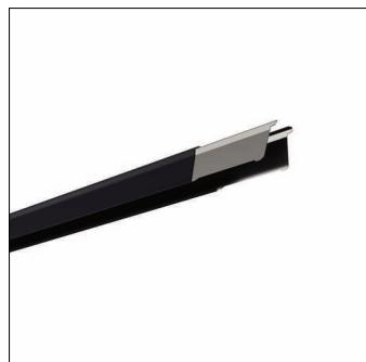
Licross, canale portante, in lamiera di acciaio, zincata, verniciatura in bobina, nero intenso opaco (RAL 9005), lunghezza: 1.500 mm, larghezza: 64 mm, altezza: 67mm, grado di protezione (totale): massimo IP64, a seconda dei listelli e degli accessori utilizzati, classe di isolamento (totale): classe isolamento I (messa a terra), marchi di qualità: CE, UKCA, conformità LABS testata secondo VDMA 24364:2018-05, unità d'imbocco: 1 pezzo
