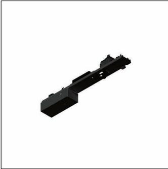
SITECO Connect IP Gen.1, inserto canale, adattatore universale PoE, con spina, a 6 poli, con selezione di fase, allacciamento alla rete: 230V, AC, 50Hz, adattatore, in lamiera di acciaio, verniciatura in bobina, nero intenso (RAL 9005), lunghezza: 500mm, larghezza: 64mm, altezza: 65mm, grado di protezione (totale): IP40, classe di isolamento (totale): classe isolamento I (messa a terra), marchi di qualità: CE, UKCA, unità d'imballo: 1 pezzo
