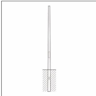
palo, palo, conico rotondo, in acciaio, zincato, altezza: 10m, imbocco: 76mm (su palo diritto), messa a terra: alt.= 1500mm / Ø= 202mm, norma: DIN EN 40, unità d'imballo: 1 pezzo
