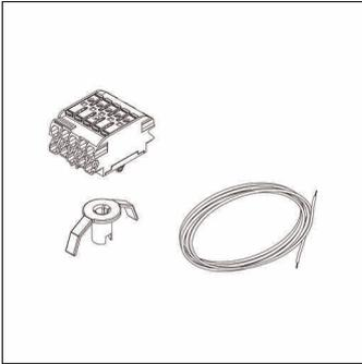
Monsun® 11/21, cablaggio passante, tipo di montaggio: montaggio a incasso, kit cablaggio passante, 3 conduttori, 2,5mm<sup>2</sup>, lunghezza cavo: 1,4m, morsetto, 3 poli, max. 2,5mm<sup>2</sup>, con conduttore di protezione, classe di isolamento (totale): classe isolamento I (messa a terra), unità d'imballo: 1 pezzo
