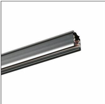
AX T, canale elettrificato trifase, tipo di montaggio: montaggio a sospensione, a plafone, alimentatore: ON/OFF, allacciamento alla rete: 220..240V/380..400V, AC, in alluminio estruso, verniciato, nero intenso (RAL 9005), lunghezza: 2.000mm, larghezza: 32mm, altezza: 33mm, grado di protezione (totale): IP20, classe di isolamento (totale): classe isolamento I (messa a terra), marchi di qualità: CE, ENEC, unità d'imballo: 1 pezzo
