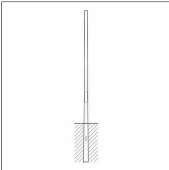
palo, palo, conico rotondo, in acciaio, verniciato con polveri, ferro micaceo Siteco® (DB 702S), altezza: 4,0m, imbocco: 76mm (su palo diritto), messa a terra: alt.= 800mm / Ø= 129mm, norma: DIN EN 40, unità d'imballo: 1 pezzo
