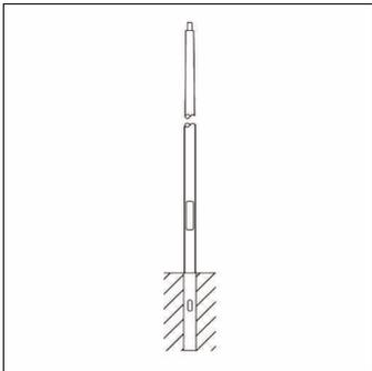
palo, palo, conico rotondo, in St 37-2, verniciato con polveri, ferro micaceo Siteco® (DB 702S), altezza: 4,0m, imbocco: 76mm (su palo diritto), messa a terra: alt.= 800mm / Ø= 151mm, norma: DIN EN 40, unità d'imballo: 1 pezzo
