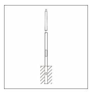
palo, palo, conico rotondo, in St 37-2, verniciato con polveri, ferro micaceo Siteco $^{\circ}$  (DB 702S), altezza: 5,0m, imbocco: 76mm (su palo diritto), messa a terra: alt.= 800mm /  $\emptyset$ = 163mm, norma: DIN EN 40, unità d'imballo: 1 pezzo
