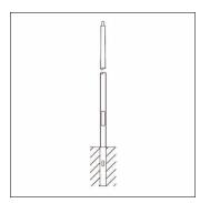
palo, palo, conico rotondo, in St 37-2, verniciato con polveri, ferro micaceo Siteco® (DB 702S), altezza: 6,0m, imbocco: 76mm (su palo diritto), messa a terra: alt.= 1000mm / Ø= 178mm, norma: DIN EN 40, unità d'imballo: 1 pezzo
