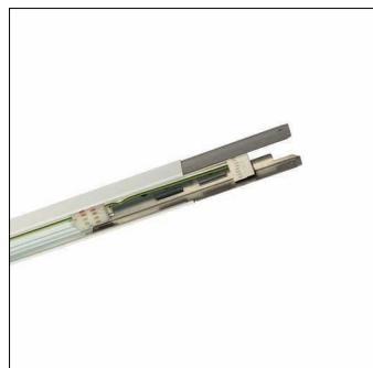
Modario, canale portante, in lamiera di acciaio, verniciato, bianco, lunghezza singola, lunghezza: 1.495 mm, larghezza: 58 mm, altezza: 43mm, cabaggio passante: 5x 2,5mm<sup>2</sup>, con morsetto, a 5 poli, max. 2,5mm<sup>2</sup>, grado di protezione (totale): per grado di protezione IP20/IP40, classe di isolamento (totale): classe isolamento I (messa a terra), marchi di qualità: CE, ENEC, VDE, norma: EN 60598, unità d'imballo: 1 pezzo
