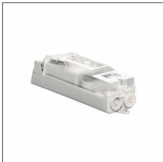
morsettiera di collegamento, per 3 cavi fino a 5x 10mm<sup>2</sup>, L1/L2/L3/N/PE(N), 2x E14, morsettiera di collegamento, in materiale plastico, resistente agli urti, diametro interno palo: da 84mm, grado di protezione (totale): IP44, classe di isolamento (totale): classe isolamento II (messa a terra), marchi di qualità: CE, unità d'imballo: 1 pezzo
