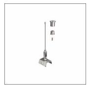
Licross®, sostegno a cavetto, custodia da soffitto, in acciaio inox (V2A), brillante, diametro: 1,5mm, cavo, in acciaio, zincato, fissaggio lato binari, in acciaio per molle V2A, unità d'imballo: 1 kit = 25 pezzi
