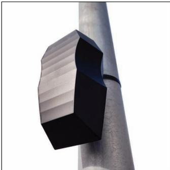
SITECO Connect WirelessMast Box Motion Radar, tipo di montaggio: a plafone, luogo di montaggio: al montante, in materiale plastico, tensione: 230V, tipo tensione: AC, 2,4GHz, rete radio mesh locale, DALI, impostazione locale e funzionamento con chiavetta USB, per movimento, 2 sensori di movimento radar, sensore di movimento radar, radio, 2,4GHz, grado di protezione (totale): IP66, marchi di qualità: CE, unità d'imballo: 1 pezzo
