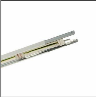
Modario® IP64, Tragschiene, aus Stahlblech, verzinkt, lackiert, leuchtenweiß, 3längig, Länge: 4.485 mm, Breite: 58 mm, Höhe: 43mm, Durchverdrahtung: 10x 2,5mm<sup>2</sup>, mit Klemme, 10polig, max. 2,5mm<sup>2</sup>, Schutzart (gesamt): für Schutzart IP64, Schutzklasse (gesamt): SK I (Schutzerdung), Prüfzeichen: CE, ENEC, VDE, Norm: EN 60598, Verpackungseinheit: 1 Stück
