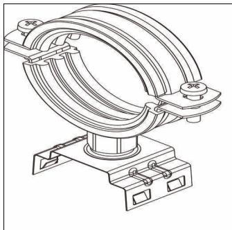
Monsun 11/21, Rohrschellen-Befestigung, Montageart: Anbau, Montage-Set, bestehend aus je 2x Rohrschelle aus galvanisch verzinktem Stahl mit Gummieinlage, Zylinderkopf-Schraube, Befestigungsclip für Leuchte aus V2A sowie 2x Befestigungsverstärkung aus UV-stabilisiertem PC, Klemmbereich: für Rohrdurchmesser 2", Verpackungseinheit: 1 Satz = 2 Stück
