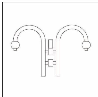
Große Glocke, Mastbogen, Mastbogen, abgesetzt, aus Stahl, verzinkt, lackiert, SITECO eisenglimmer (DB 702S), 2armig, mit Bajonettverschluss, Durchmesser: 76mm, Höhe: 1040mm, Zopfmaß: 76mm (Aufsatz), Verpackungseinheit: 1 Stück
