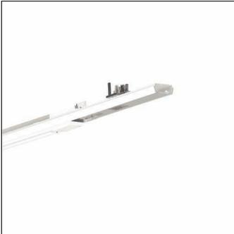
Modario®, Stromschieneneinsatz, Vorschaltgerät: EIN/AUS, mit Stecker, 5polig, mit Phasenwahl, für Tragschiene, 5- oder 10adrig, Netzanschluss: 230/400V, Stromschienen-Einsatz, aus Stahlblech, bandlackiert, leuchtenweiß, 4x Systemmaß, max. Gewichtsbelastung 5kg, Länge: 1.196mm, Breite: 48mm, Schutzart (gesamt): für Schutzart IP20, Schutzklasse (gesamt): SK I (Schutzerdung), Prüfzeichen: CE, Verpackungseinheit: 1 Stück
