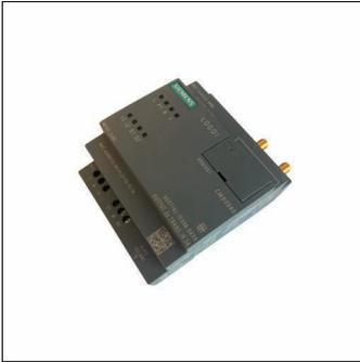
SITECO Connect Group, Kommunikationsbaustein, Montageart: DIN-Schienen-Montage, Netzanschluss: 12/24V, DC, Gehäuse, aus Kunststoff, grau, 4 Teileinheiten, Länge: 58mm, Breite: 72mm, Höhe: 90mm, Kommunikationsmodul, Verteilungseinbauvernetzbar Ausführung, Ausstattung: Steckplatz für SIM-Karte, Steckplatz für microSD-Karte, Schutzart (gesamt): IP20, Prüfzeichen: CE, zul. Betriebsumgebungstemperatur für Außenanwendungen: -20..+70°C, zul. Lagertemperatur: -20..+85°C, Verpackungseinheit: 1 Stück
