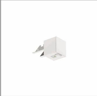
Silica 21Sensor PR3, Slave, lokale Steuerung - autarke standalone Sensorik, dimmbar, Montageanordnung: Einzel-/Bandanordnung, Montageart: Einsteckmontage, Montageort: an der Silica 21 Leuchte, aus Alu-Strangpreßprofil, Schutzart (gesamt): IP20, Schutzklasse (gesamt): SK I (Schutzerdung), Prüfzeichen: CE, 1 x PIR-Bewegungssensor, 1 x Lichtsensor, Verpackungseinheit: 1 Stück
