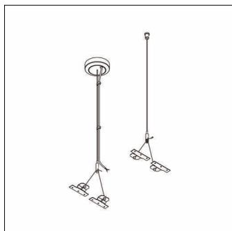
Apollon 2, Y-Seilabhängung, Deckenhülse, mit mit 2 Klemmen, 1polig, max. 2,5mm<sup>2</sup>, Anschlussleitung, 2X0,75mm<sup>2</sup>, Deckenbefestigungselement, aus Stahl, verzinkt, Baldachin, aus Kunststoff, Seil, aus Stahl, verzinkt, leuchttenseitige Befestigung, aus Stahl, verzinkt, Deckenhülse, aus Stahl, vernickelt, Verpackungseinheit: 1 Satz = 2 Stück
