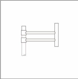
Schiene, Mastausleger, Designausleger, aus Stahl, verzinkt und lackiert, Siteco® eisenglimmer (DB 702S), 1armig, mit integriertem Mastabschluss, Zopfmaß: 76mm (Aufsatz), Auslegermaß: 600mm, Verpackungseinheit: 1 Stück
