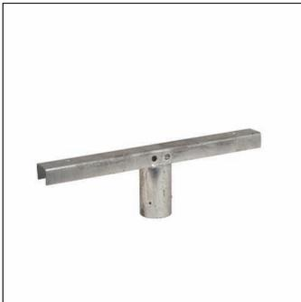
SiCOMPACT® A2 MIDI, Baugruppe Montage, Traverse für 2 Fluter, aus Stahl, verzinkt, Typ 1: Aufsatz, Länge: 660 mm, Zopfmaß: 89mm, Verpackungseinheit: 1 Stück
