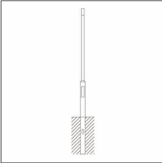
Mast, Mast, zylindrisch abgesetzt, aus Stahl, verzinkt, Höhe: 3,5m, Zopfmaß: 76mm (Aufsatz), Erdstück: h= 600mm / Ø= 114mm, Norm: DIN EN 40, Verpackungseinheit: 1 Stück
