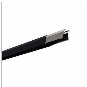
Licross, Tragschiene, aus Stahlblech, verzinkt, bandlackiert, tiefschwarz matt (RAL 9005), Länge: 3.000 mm, Breite: 64 mm, Höhe: 67mm, Durchverdrahtung: 9x 2,5mm<sup>2</sup>, Schutzart (gesamt): maximal IP64, abhängig von den verwendeten Einsätzen und Zubehören, Schutzklasse (gesamt): SK I (Schutzerdung), Prüfzeichen: CE, UKCA, LABS-Konformität geprüft gemäß VDMA 24364:2018-05, Verpackungseinheit: 1 Stück
