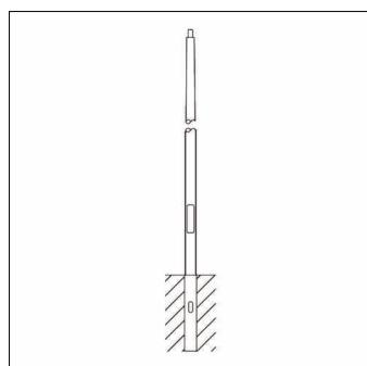
Mast, Mast, konisch rund, aus St 37-2, pulverbeschichtet, SITECO eisenglimmer (DB 702S), Höhe: 4,0m, Zopfmaß: 76mm (Aufsatz), Erdstück: h= 800mm / Ø= 151mm, Norm: DIN EN 40, Verpackungseinheit: 1 Stück
