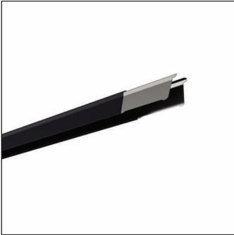
Licross®, Tragschiene, aus Stahlblech, verzinkt, bandlackiert, tiefschwarz matt (RAL 9005), Länge: 1.500 mm, Breite: 64 mm, Höhe: 67mm, Durchverdrahtung: 9x 2,5mm<sup>2</sup>, Schutzart (gesamt): maximal IP64, abhängig von den verwendeten Einsätzen und Zubehören, Schutzklasse (gesamt): SK I (Schutzerdung), Prüfzeichen: CE, UKCA, LABS-Konformität geprüft gemäß VDMA 24364:2018-05, Verpackungseinheit: 1 Stück
