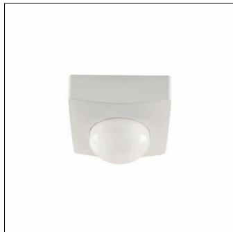
SITECO ConnectSensor-Head PC5-S, Slave, lokale Steuerung - autarke standalone Sensorik, zentrale Steuerung - Anbindung an Licht- oder Gebäudemanagement, dimmbar, Montageart: Einstechmontage, Montageort: an der Decke, an der Modario Tragschiene, an der Licross Tragschiene, aus Kunststoff, Schutzart (gesamt): IP54, Prüfzeichen: CE, VDE, 1 x PIR-Bewegungssensor, 1 x Lichtsensor, Verpackungseinheit: 1 Stück
