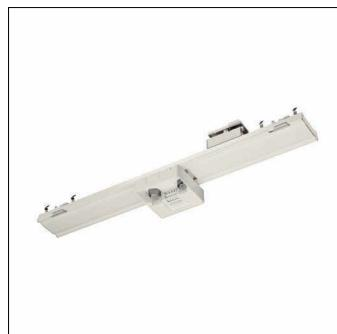
Licross InterfaceMD, Master, lokale Steuerung - autarke standalone Sensorik, dimmbar, Montageort: an der Licross Tragschiene, aus Stahlblech, Schutzart (gesamt): IP20, Schutzklasse (gesamt): SK I (Schutzerdung), Prüfzeichen: CE, ENEC, VDE, UKCA, Spannung: 230V, Spannungsart: AC, 1 x 1 x DALI, 1 x Relaiskontakt, Verpackungseinheit: 1 Stück
