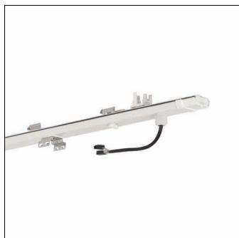
Monsun 11 Extreme, Schieneneinsatz, Leuchten-Montage-Einsatz, mit Systemverbindung Leuchte: Buchse, 5polig; für Modario Tragschiene, 10adrig, Netzanschluss: 220..240V, AC/DC, 0/50..60Hz, Stirnwand, aus PC, weiß, Länge: 1.495mm, Breite: 48mm, Leuchten-Montage-Einsatz, aus Stahlblech, verzinkt, lackiert, leuchtenweiß, Schutzart (gesamt): IP64, Schutzklasse (gesamt): SK I (Schutzerdung), Prüfzeichen: CE, ENEC, VDE, UKCA, Schutzzeichen: D, Verpackungseinheit: 1 Stück
