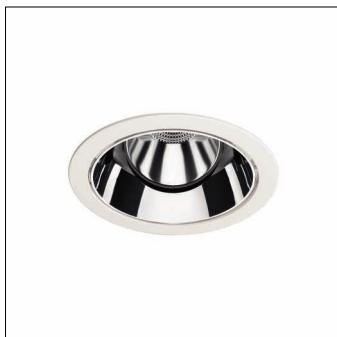
Lunis 11 mini round Spot, Downlight, LED Bemessungslichtstrom: 3.220lm, Lichtfarbe: 830, mit Klemme, 5polig, Netzanschluss: 220..230V, AC, 50/60Hz, LED-Modul, Leuchtenmodul, aus Aluminium-Druckguss, lackiert, silber, Durchmesser: 176mm, Klemmbereich: 1..40mm, Einbauring, rund, aus PC, verkehrsweiß (RAL 9016), Schutzart (gesamt): IP20, Schutzklasse (gesamt): SK II (Schutzisoliert), Prüfzeichen: CE, zul. Umgebungstemperatur für Innenräume: 0..+35°C, Verpackungseinheit: 1 Stück
