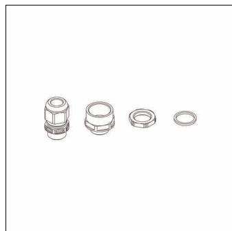
Monsun 11/21, Leitungseinführung, Kabelverschraubung, aus PA / Silikon,
