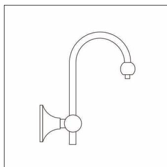
Kleine Glocke, Wandausleger, Wandausleger, aus Stahl, verzinkt, lackiert, SITECO eisenglimmer (DB 702S), 1armig, mit Bajonettverschluss, Höhe: 829mm, Verpackungseinheit: 1 Stück
