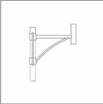
Schwinge, Mastausleger, Designausleger, aus Stahl, verzinkt und lackiert, Siteco® eisenglimmer (DB 702S), 1armig, mit integriertem Mastabschluss, Zopfmaß: 76mm (Aufsatz), Auslegermaß: 600mm, Verpackungseinheit: 1 Stück
