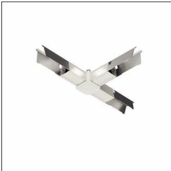
Licross® T-Verbinder, weiß; Tragschienen-Element aus Stahl, verzinkt, lackiert, mit Leitungseinführung für sechs Leitungen, Ø 8, 5..13mm; Blindabdeckung aus PC/ABS, weiß, 3x Verbinder aus Stahl, verzinkt, Abmessung: (LxBxH) = 300 x 197 x 67mm; für Schutzart IP20/IP40; Prüfzeichen: CE, UKCA; Verpackungseinheit: 1 Stück
