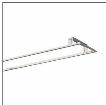
Sport 31, Deckeneinbaurahmen, Montageart: Einbau, Einbau-Rahmen, aus Stahlblech, verkehrsweiß (RAL 9016), inkl. Schrauben, Länge: 1.582mm, Breite: 358mm, Höhe: 105mm, Klemmbereich: 10..60mm, Verpackungseinheit: 1 Stück
