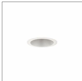
Lunis 31-L, Downlight, Lichtlenkung mit Reflektor, Lichtaustritt: direkt strahlend, LED Bemessungslichtstrom: 1.650lm, Lichtfarbe: 830, Netzanschluss: 220..240V, AC/DC, 0/50..60Hz, Gehäuse, aus Aluminium, weiß, Schutzart (gesamt): IP20, Schutzart (raumseitig): IP54, Schutzklasse (gesamt): SK II (Schutzisoliert), Prüfzeichen: CE, ENEC, Verpackungseinheit: 1 Stück
