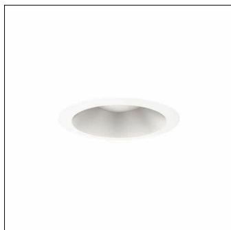
Lunis 31-XL, Downlight, Lichtlenkung mit Reflektor, Lichtaustritt: direkt strahlend, LED Bemessungslichtstrom: 2.500lm, Lichtfarbe: 830, Netzanschluss: 220..240V, AC/DC, 0/50..60Hz, Gehäuse, aus Aluminium, weiß, Schutzart (gesamt): IP20, Schutzart (raumseitig): IP54, Schutzklasse (gesamt): SK II (Schutzisoliert), Prüfzeichen: CE, ENEC, Verpackungseinheit: 1 Stück
