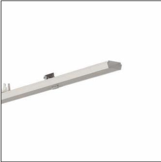
Modario®, Blindeinsatz, aus Stahl, bandlackiert, weiß, Stirnwand, aus ABS, transparent, Länge: 2.392mm, Breite: 48mm, 8x Systemmaß, für Industrieanlagen, Labor/Entwicklung/Technikum, Lager/Logistik, Montage/Produktion/Verfahren, Produktions- und Lagerhallen, Sonderbereiche/Nebengebäude, Schutzart (gesamt): für Schutzart IP20, Schutzklasse (gesamt): SK I (Schutzerdung), Prüfzeichen: CE, Verpackungseinheit: 1 Stück
