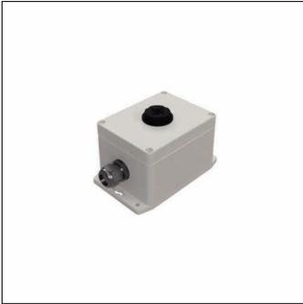
SITECO Connect Wireless, Anschlussbox, Montageart: Anbau, Netzanschluss: 230V, AC, 50/60Hz, Anbaugehäuse, aus Kunststoff, hellgrau, Länge: 115mm, Breite: 80mm, Höhe: 140mm, Smart Plug Box, Schutzart (gesamt): IP65, Prüfzeichen: CE, zul. Betriebsumgebungstemperatur für Außenanwendungen: -15..+45°C, Norm: nach Zhaga Buch 18, Verpackungseinheit: 1 Stück
