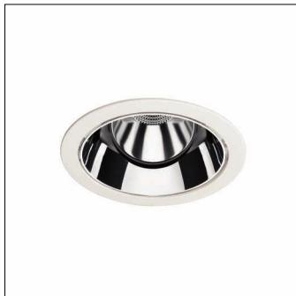
Lunis 11 mini round Spot, Downlight, LED Bemessungslichtstrom: 1.020lm, Lichtfarbe: 830, mit Klemme, 5polig, Netzanschluss: 220..230V, AC, 50/60Hz, LED-Modul, Leuchtenmodul, aus Aluminium-Druckguss, lackiert, silber, Durchmesser: 176mm, Klemmbereich: 1..40mm, Einbauring, rund, aus PC, verkehrsweiß (RAL 9016), Schutzart (gesamt): IP20, Schutzklasse (gesamt): SK II (Schutzisoliert), Prüfzeichen: CE, zul. Umgebungstemperatur für Innenräume: 0..+35°C, Verpackungseinheit: 1 Stück
