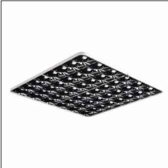
Spiegel-Werfer-Reflektor, für Siteco Mirrortec® Indoor, Kugelgelenk-Pendelabhängung, Gehäuse, quadratisch, aus Aluminium, lackiert, weißaluminium (RAL 9006), Fresnel Reflektor 100, aus PMMA, Alu bedampft, hochglänzend, Lichtpunkt-Zerlegung, Fresnelstruktur, Länge: 600 mm, Breite: 600 mm
