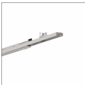
Modario, Stromschieneneinsatz, Vorschaltgerät: EIN/AUS, mit Stecker, 5polig, mit Phasenwahl, für Tragschiene, 5- oder 10adrig, Netzanschluss: 230/400V, Stromschienen-Einsatz, aus Stahlblech, bandlackiert, weißaluminium (RAL 9006), 4x Systemmaß, max. Gewichtsbelastung 5kg, Länge: 1.196mm, Breite: 48mm, Schutzart (gesamt): für Schutzart IP20, Schutzklasse (gesamt): SK I (Schutzerdung), Prüfzeichen: CE, Verpackungseinheit: 1 Stück
