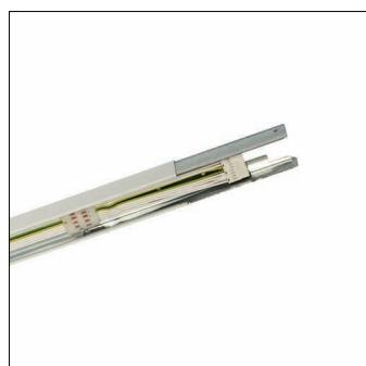
Modario IP64, Tragschiene, aus Stahlblech, verzinkt, lackiert, leuchtenweiß, 1längig, Länge: 1.495 mm, Breite: 58 mm, Höhe: 43mm, Durchverdrahtung: 10x 2,5mm<sup>2</sup>, mit Klemme, 10polig, max. 2,5mm<sup>2</sup>, Schutzart (gesamt): für Schutzart IP64, Schutzklasse (gesamt): SK I (Schutzerdung), Prüfzeichen: CE, ENEC, VDE, Norm: EN 60598, Verpackungseinheit: 1 Stück
