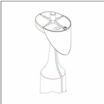
Modul 540; Blende für rückseitige Abschirmung aus Aluminium, reinweiß (RAL 9010); Höhe: 150mm; Verpackungseinheit: 1 Stück
